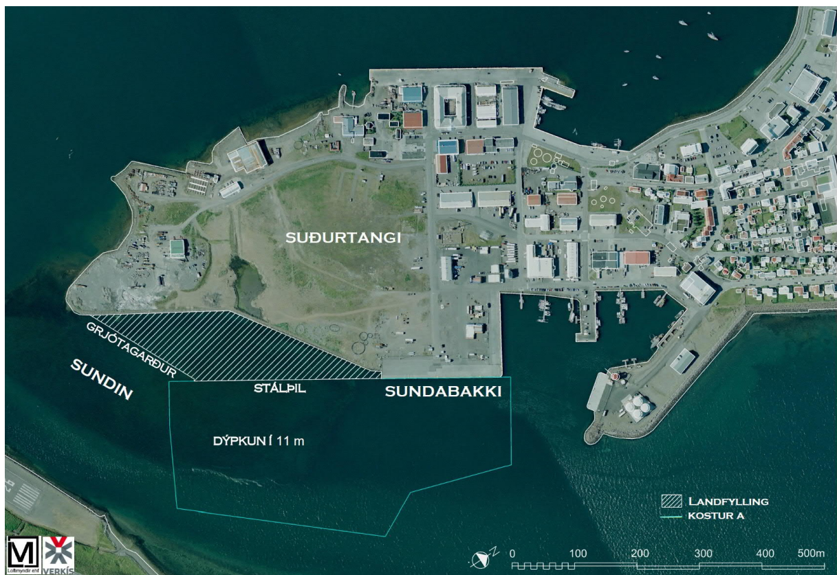
Mynd 2-1 Lenging Sundabakka og dýpkun við viðlegukant í allt að 11 metra. Dýpi verður óbreytt á um 20 m breiðu svæði næst núverandi hafnarkanti í samræmi við hönnun gamla stálpilsins.
